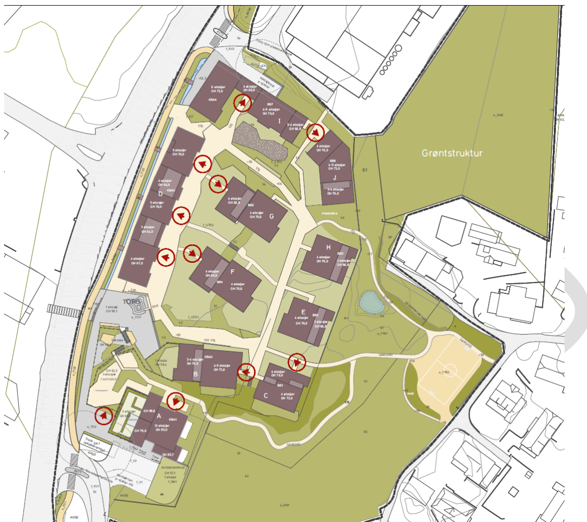
Figur 72 Tilkomst sykkelparkering. I illustrasjonsprosjektet er sykkelparkeringen fordelt for å gi rask og god tilgjengelighet til de ulike målpunktene. Parkeringen er lagt i byggenes 1. etasje, samt høyhuset 3. etasje, med direkte og god tilkomst fra planlagte gangveger.
