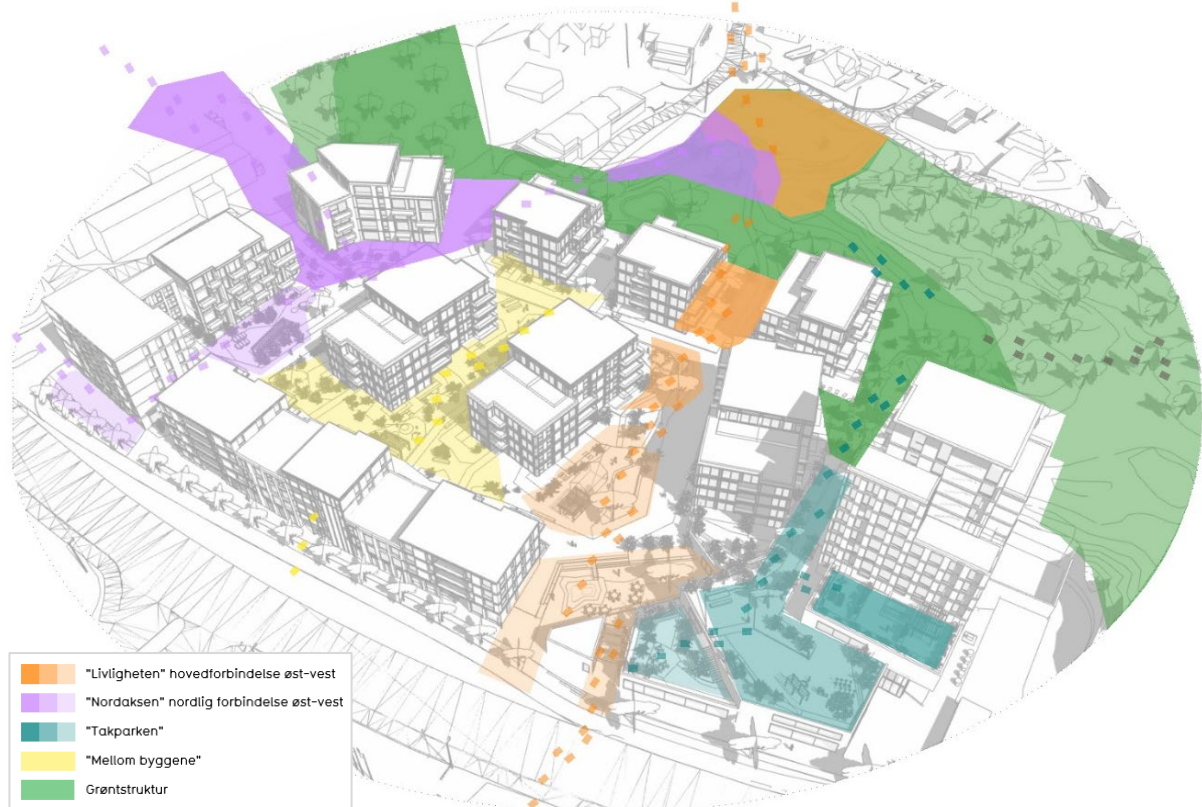
Figur 57 Diagram for uteoppholdsareal. Utearealene er delt inn i fire soner med ulik programmering: «Hovedaksen» (oransje), «Nordaksen» (lilla), «Takuparken» (blå) og «Mellom byggene» (gul).
