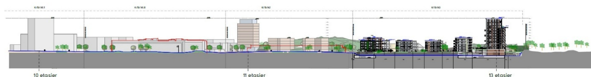
Figur 13 Snitt med høyhus innenfor planområdet til høyre, og regulert byggehøyde for K/B/A1.1 +95 ytterst til venstre.
