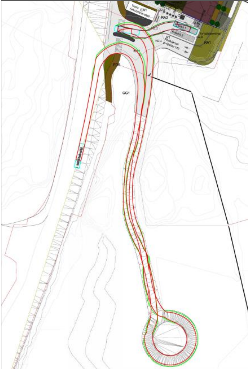
Figur 11: Alternativ tilkomst og avkjørsel for renovasjonsbil på hente plass i sør. Røde spor: kjøring forover, mørk røde spor: rygging, grønne linjer: overheng (Marianne Ø. Aasebø i En-til-En arkitekter)
