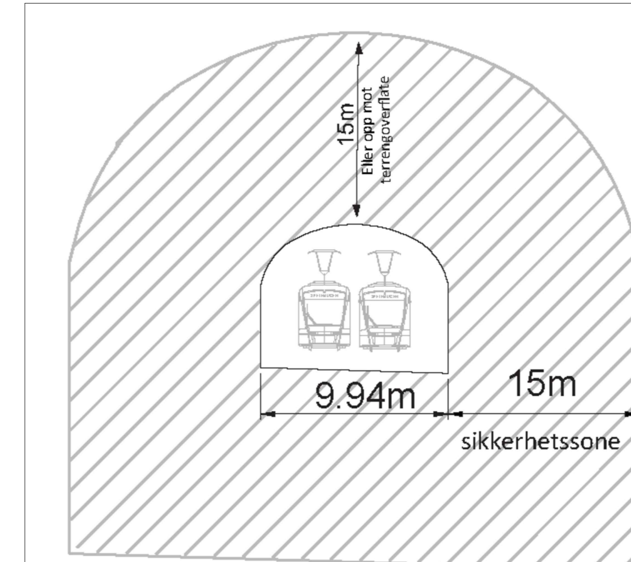
Prinsipp for sikrings- og justeringszone for tunnel
