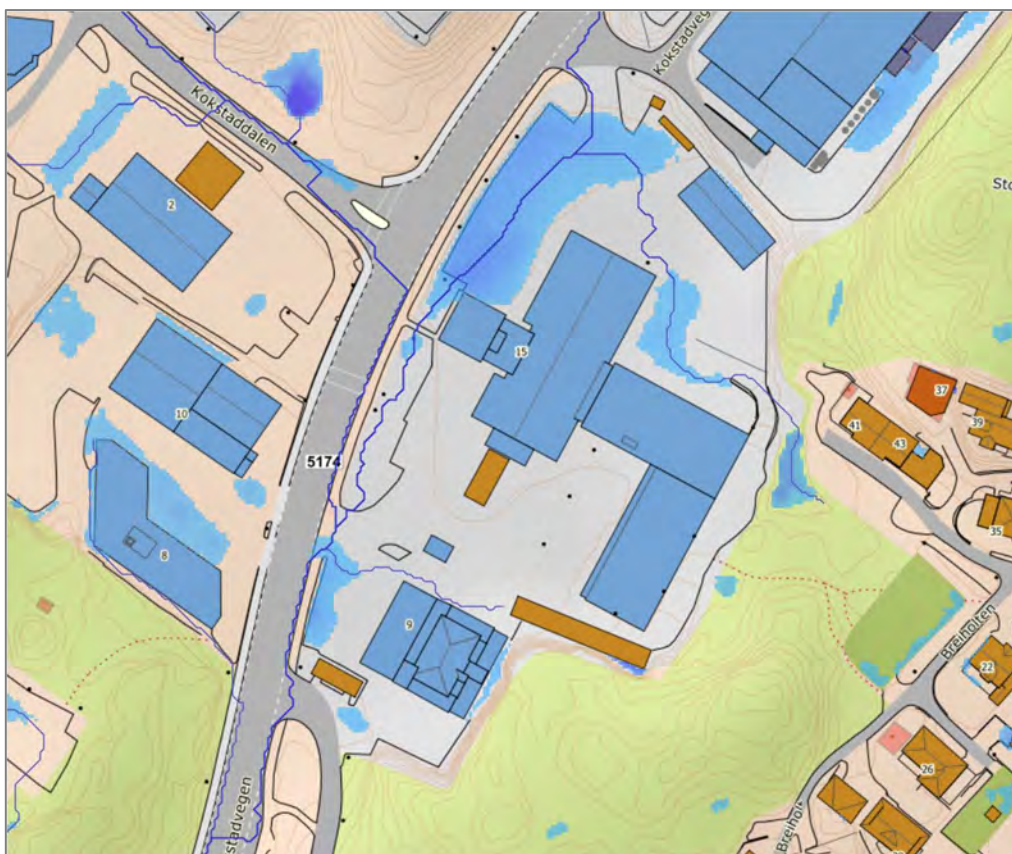
Figur 2: Avrenningsmønster basert på terrengmodell fra høydedata (Scalگو Live)
