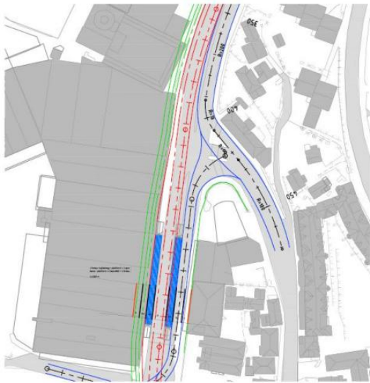
Figur 5-78: Illustrasjon hentet fra tilleggsutredning nr. 12 i KU for bybanen Sentrum – Åsane som viser nødvendig tverrsnitt for fremføring av bybanen.
