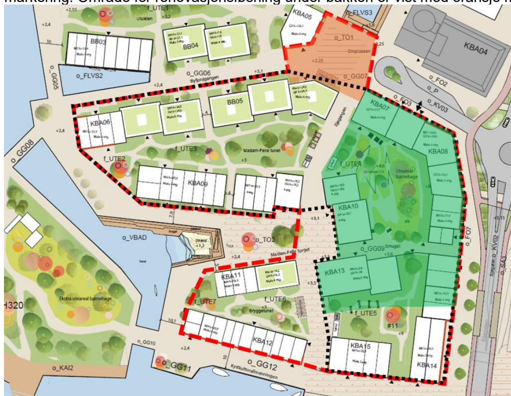
Figur 5-76: Illustrasjon som viser bestemmelsesområde #8 (rød stiplet linje). Her tillates parkeringsanlegg og renovasjonsanlegg under bakken. Svart stiplet linje er omtrentlig behov ved parkeringsdekning 0,4 per 100 m 2 BRA bolig, og grønn markering 0,2 per 100 m 2 BRA bolig
