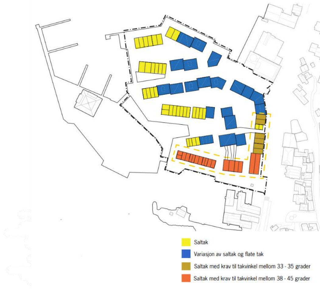
Figur 5-104: Illustrasjon som viser krav til takform og vinkel på tak.
