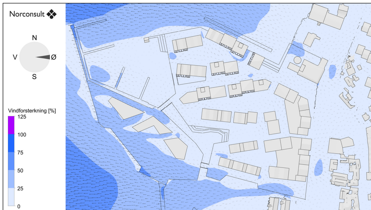
Figur 19: Vindforsterkning og strømningspiler ved vind fra 90°.
