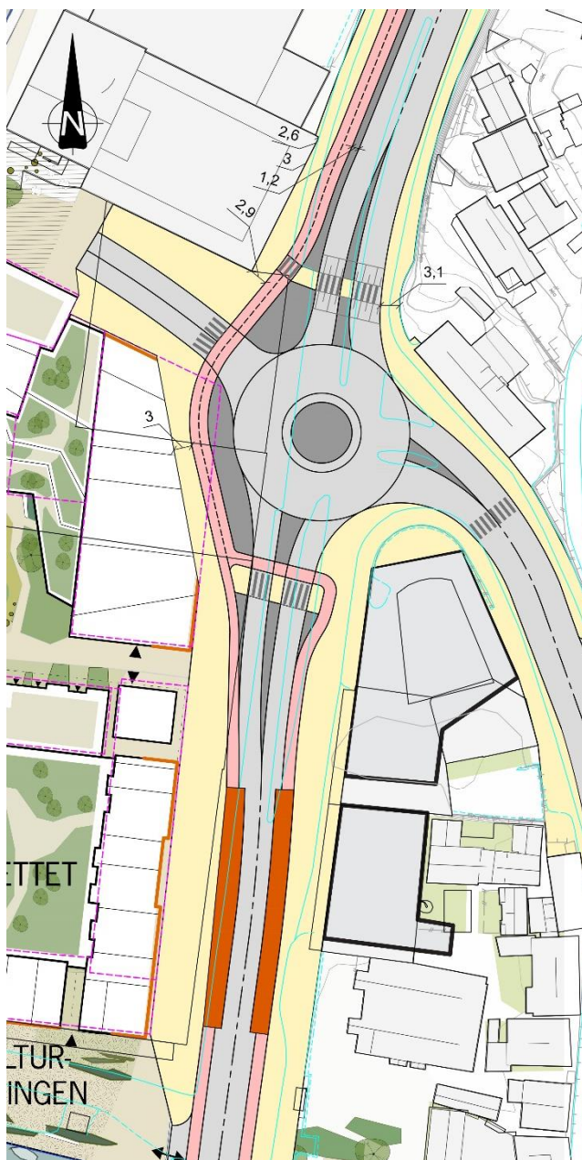
Figur 3-7: Rundkjøring med diameter 29 m. Rosa stiplet linje markerer kvartalene fra illustrasjonsplanen for Kristiansholm.
