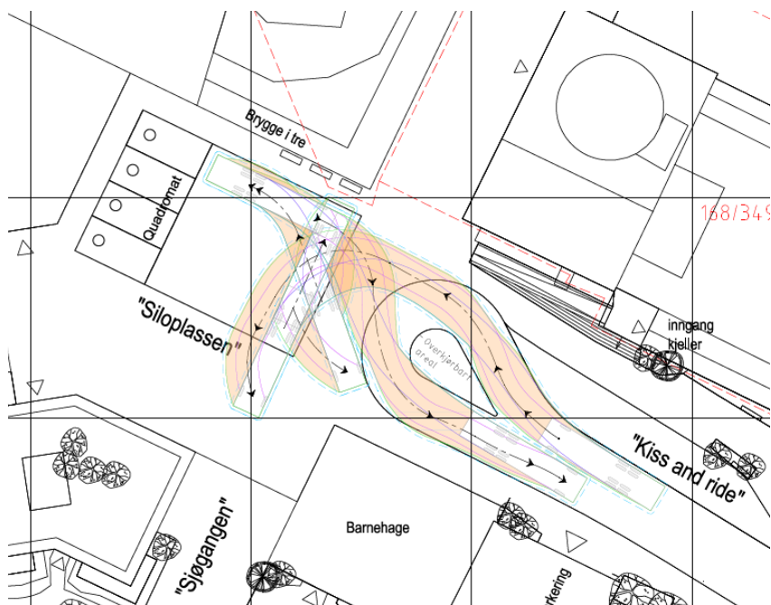
Figur 26: Tilkomst og utkjøring for renovasjonsbilen til oppstillingsplass for quadromatløsning. (utklipp fra S102)
