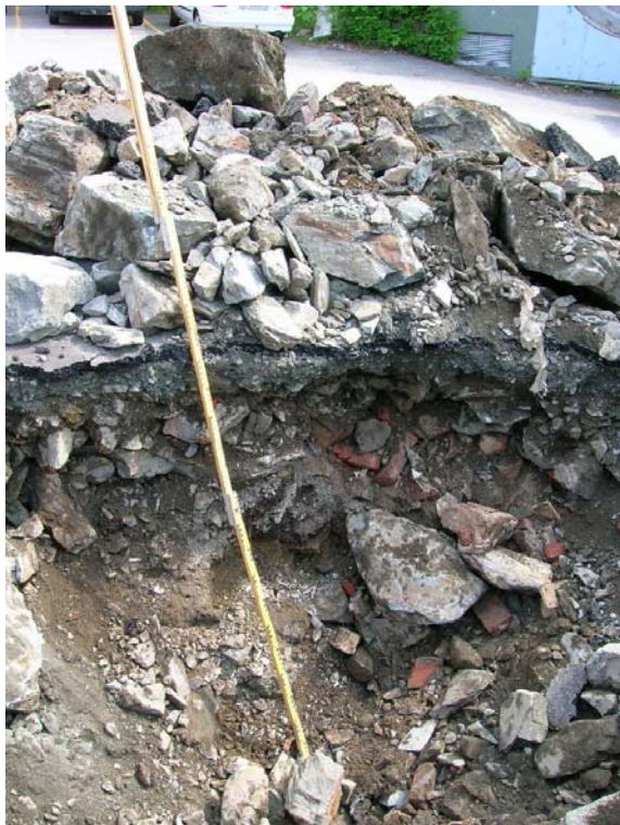
Figur 10: PG 7, blandede fyllmasser med en del teglstein og teglsteinsrester.
