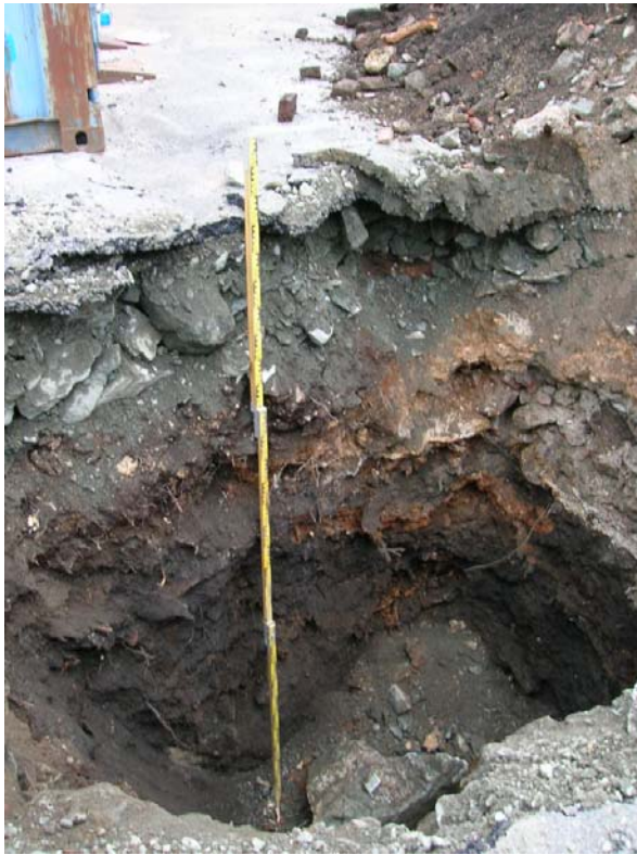
Figur 1: PG 1, avsluttet i ca. dybde 3 m. Blandede fyllmasser.
