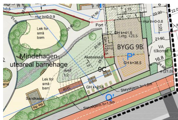
Figur 4-28. Overbygg over ny adkomst til teknisk infrastruktur under grunnen, opparbeides med møblering og som en del av barnehagens uteareal.
