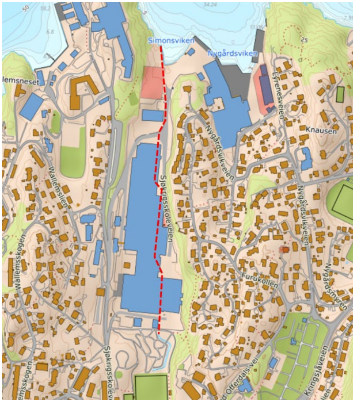
Figur 5 Kulverten under næringsparken vist med rød stiplet linje. Merk det nye bekkeløpet i Bellonaparken sør for næringsparken.
