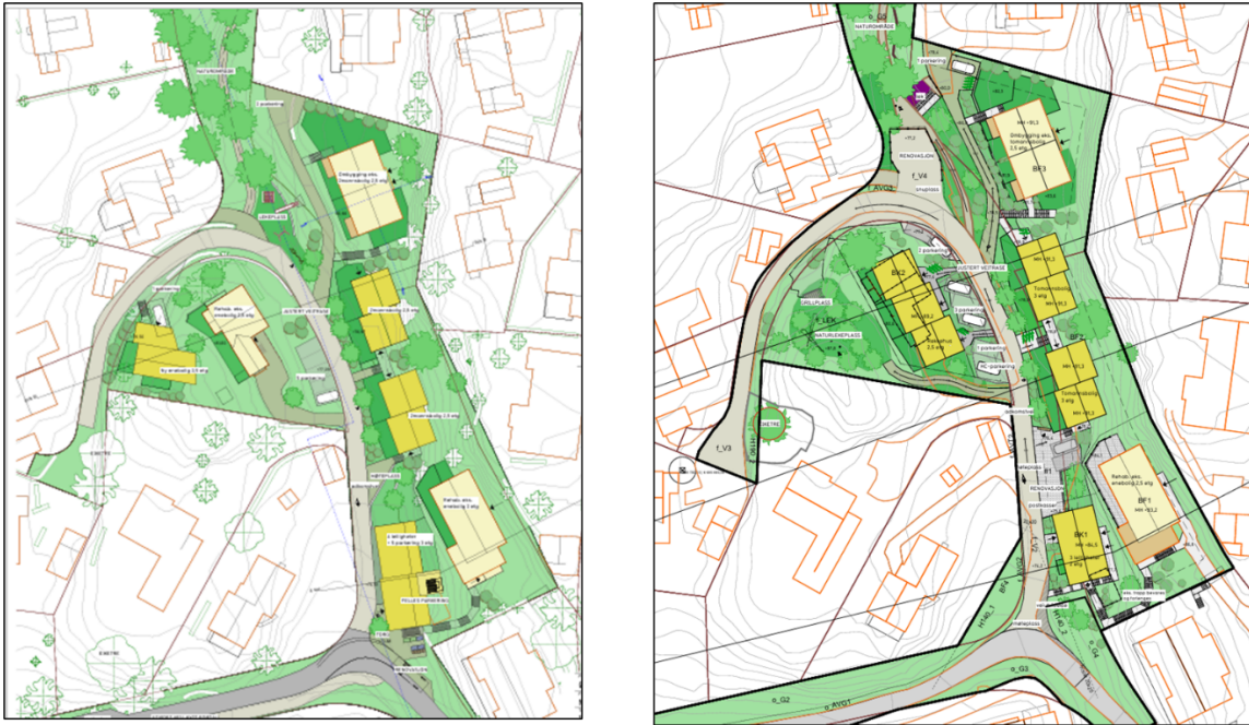
Figur 7. Til venstre: Forslag presentert i planinitiativet 30.05.2024. Til høyre: Forslag presentert 23.10.25 og som er lagt til grunn i innsendt planforslag. Lysegule bygg er eksisterende, mørkegule nye. Eksisterende bygg lengst vest er foreslått revet til erstatning for rekkehus med tre sammenhengende enheter. Huset lengst sør (nærmest avkjørsel) nedskaleres.
