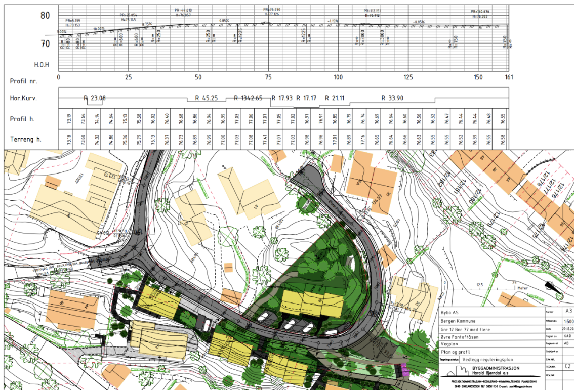
Figur 7: Plan og profil av den private delen av tilkomstvegen
