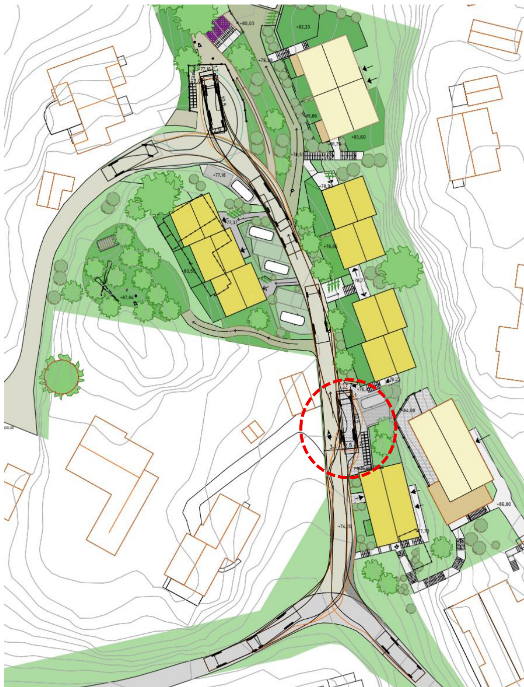
Figur 11: Oversikt over alle springer som renovasjonsbilen må ta ved henting av boss i planområdet.
