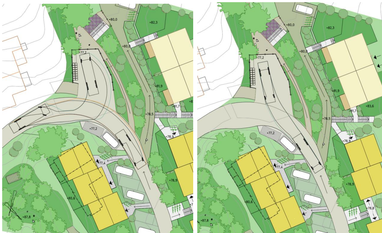
Figur 8: Springskurver for tilkomst til de to hente- og oppstillingsplassene.
