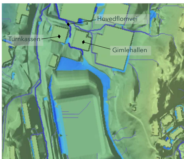
Figur 4-3 Kartutsnitt oversvømt areal og flomvei tilhørende en midlertidig fase i Slettebakken, hvor en del av søndre planområdet er oppfylt på ca. kt. +70,0.
