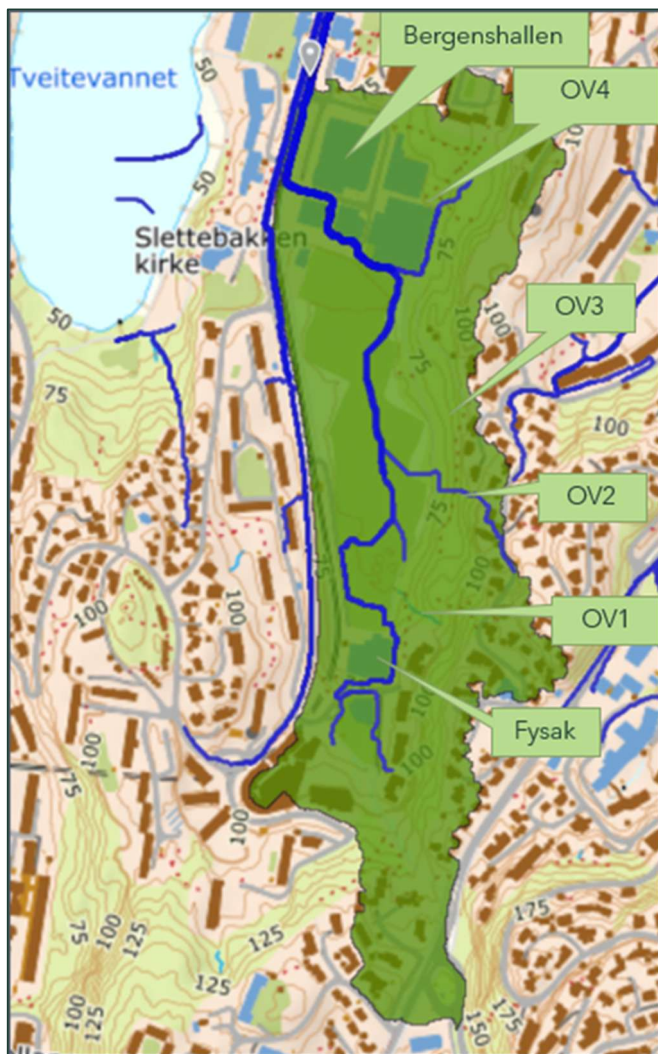
Figur 2-4 Nedbørsfelt Slettebakken. Blå linjer er avrenningslinjer (nedslagsfelt på 1 ha og større).
