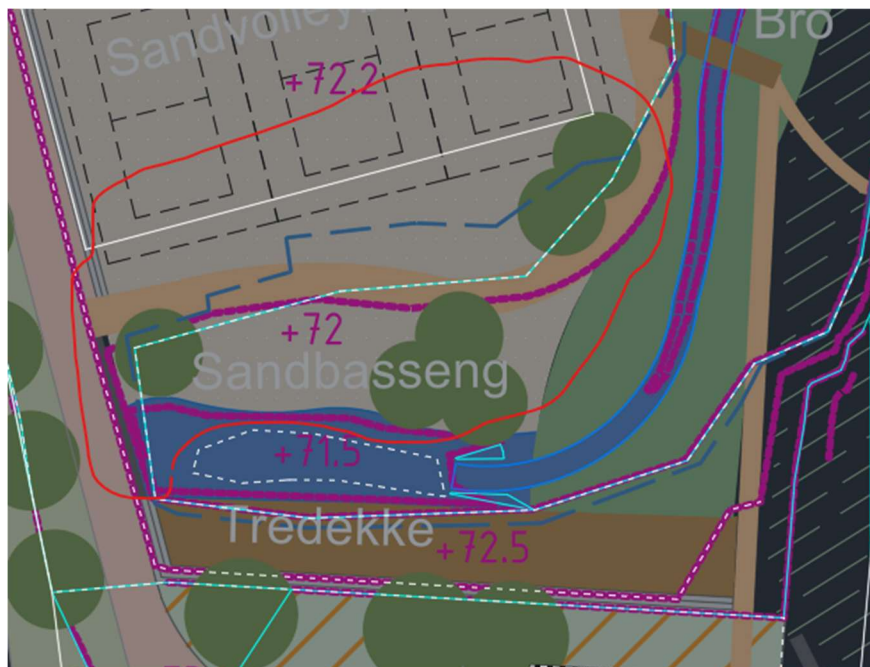
Figur 7-1 Terrengendringer i den oppdaterte illustrasjonsplanen ved overgangsdammen. Området med endret terreng er avgrenset med rød markering. Nye høydelinjer fra gjeldende illustrasjonsplan er angitt i rosa, mens høydelinjer fra tidligere plan er vist i hvitt. Vannutbredelse for klimajustert 100-års styrtregnflom (Q100+klime) er fremstilt som en blå, stripet linje.
