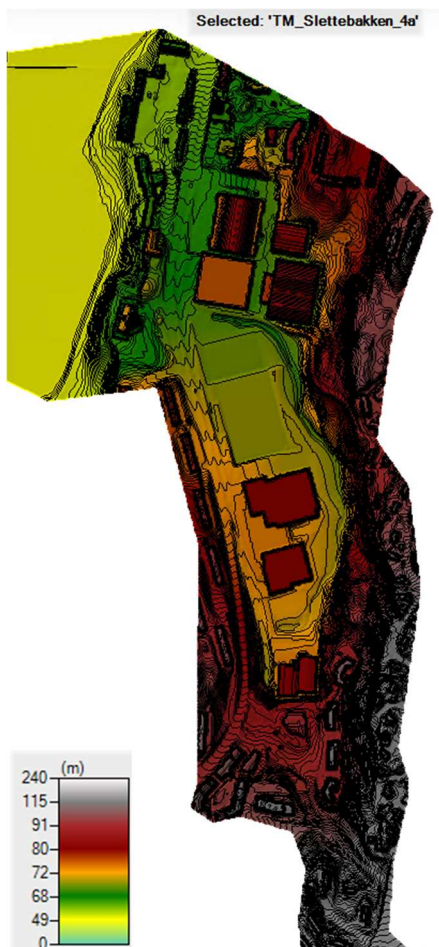
Figur 4-5 Oversikt over terrengmodellen som er benyttet til de hydrauliske beregningene i HEC-RAS
