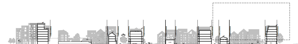
Figur 8: Tverrsnitt gjennom boligkvartalene sett fra øst, med sør til venstre og nord til høyre. Tverrsnitt viser boligbebyggelsen i forhold til indre gårdsrom, uteoppholdsarealer og byrom.
