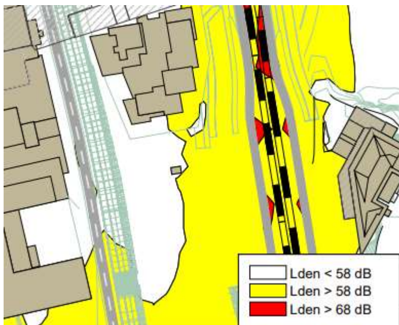
5-50 Kart over støy fra veg og bane viser at den vestre halvdelen av torgarealet har lydnivå under 58dB. Støyutredning, Multiconsult, 2025
