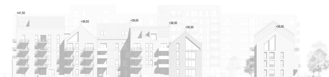
5-32 Fasade og byggehøyder B2 og B1 sett fra sykkelvegen.
