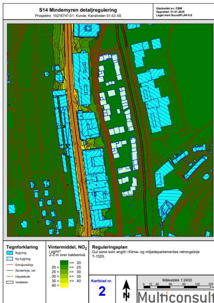
8-5 Figur som viser grønne nivå for vintermiddel NO 2 for hoveddelen av planområdet, fra vurdering av luftforurensing av delfelt S14 (Multiconsult 2022, revidert 2025)
