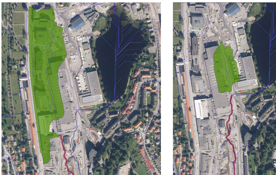
5-85 Skjermdump fra Scalgo. Nedbørsfelt for vestsiden av Mindemyren S14 og avrenning fra Nord til sør langs sykkelveg (t.v). Nedbørsfelt for østsiden av Mindemyren S14. Avrenning fra Nord til sør langs Bybane traseen (t.h) (VA-rammeplan, Multiconsult 2023)
