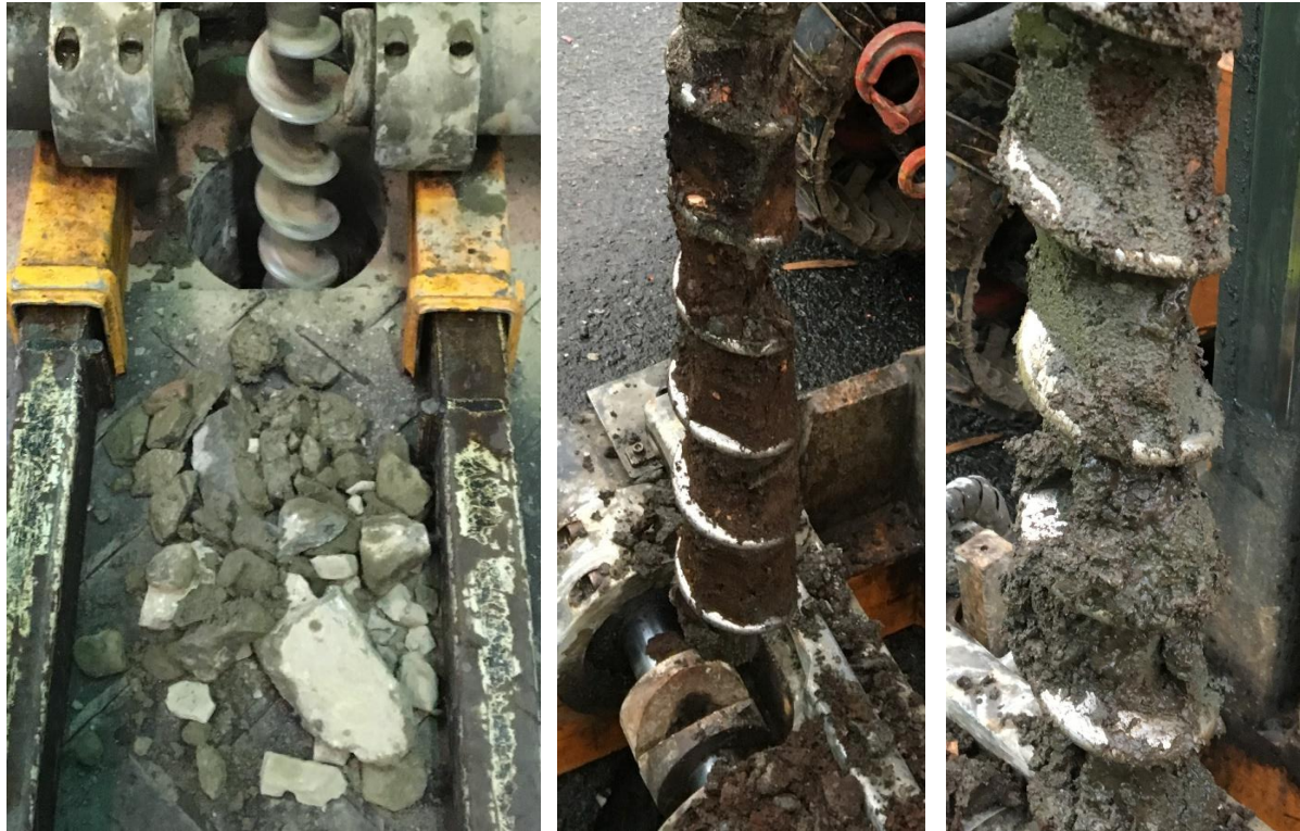
Figur 5-1: Bildet til venstre viser stein som er plukket opp fra prøvepunkt PR2. Slike mineralske fyllmasser ble observert i toppen i alle de tre prøvepunktene. Bildet i midten viser antatt stedegne torvmasser observert i ca. dybde 3,5-4,2 m i PR1. Bildet til høyre viser antatt stedegen sand i PR1, påvist fra ca. dybde 4,2 m (også observert i PR2). Foto: Multiconsult.
