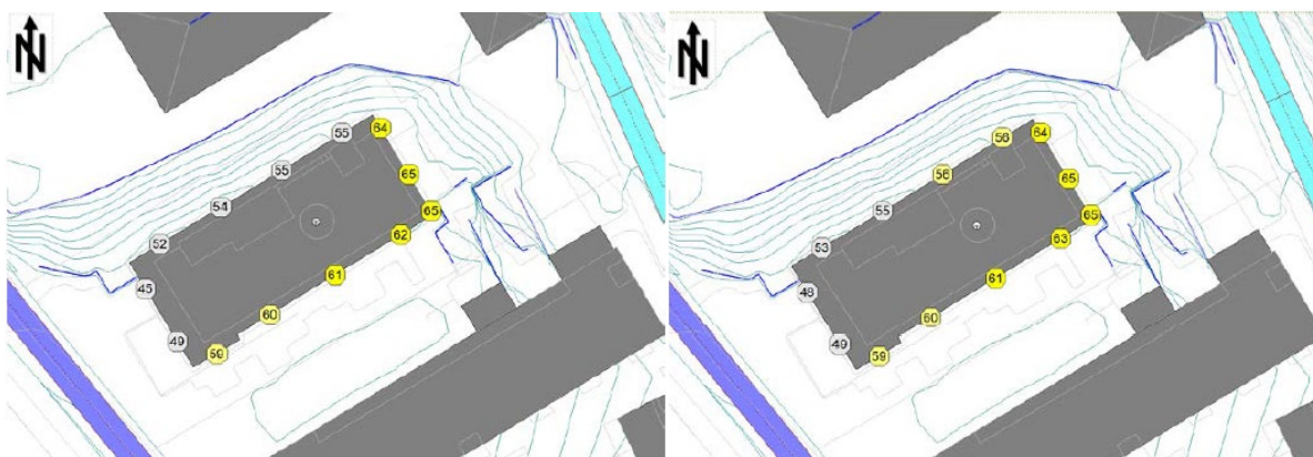
FIGUR 2 Utsnitt fra støyberegninger på 6.etasje (t.v.) og 7. etasje (t.h.) til Sandviksveien 94 viser høyere fasadestøy.
