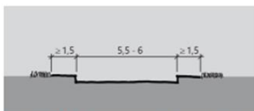
Figur B.13: Overordnet boliggate/boligveg med fortau (mål i m)
